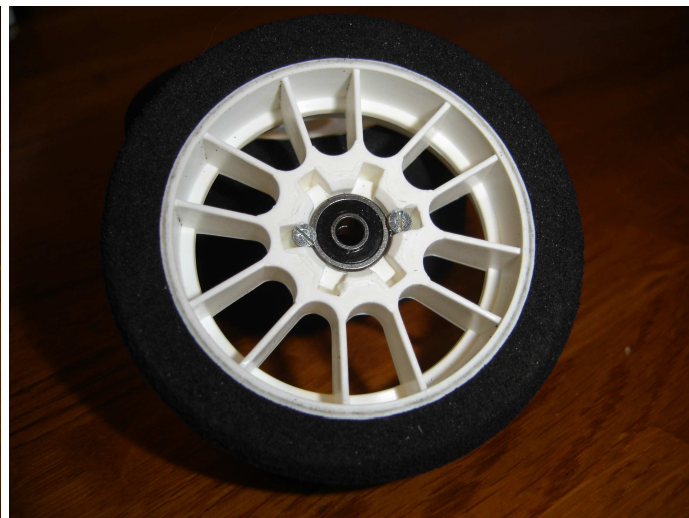
mettre en place les roulements, percer à 2mm dans le moyeu pour les boulons.
