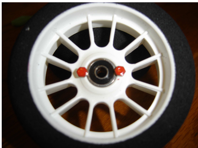
Coller les écrous au vernis sans les serrer
