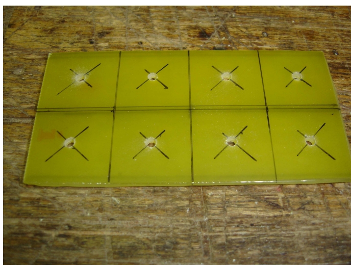
10- Tracer et pointer les centres à 3mm
