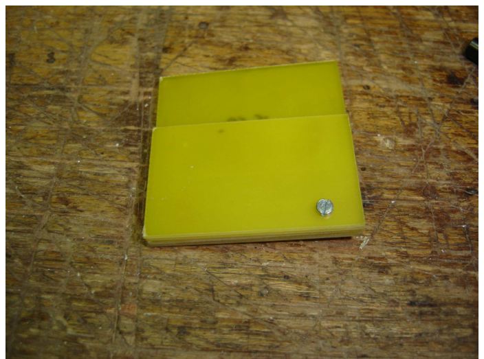
2- Assemblage des 4 plaques ensemble
