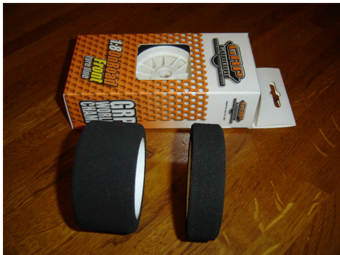
Trancher la roue à 20mm de large
